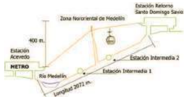
Figura 1. Estructura básica del Metrocable. Fuente: [4]
