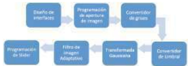
Figura 4. Diagrama de los métodos programados para tener el software que permite realizar el análisis de imágenes de geles de proteínas.
