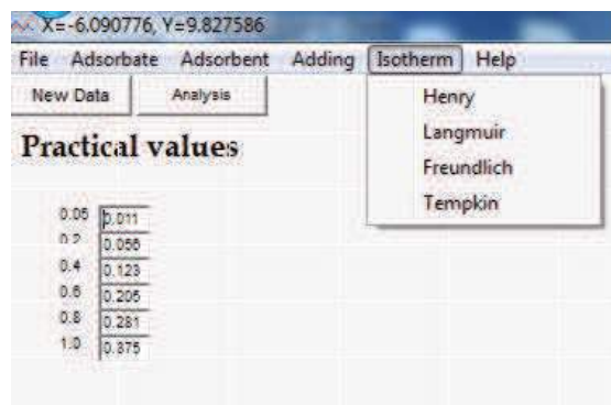
Figura 2. Interfaz que muestra los menús que permiten calcular las isothermas de Henry, Langmuir, Freundlich y Tempkin.
