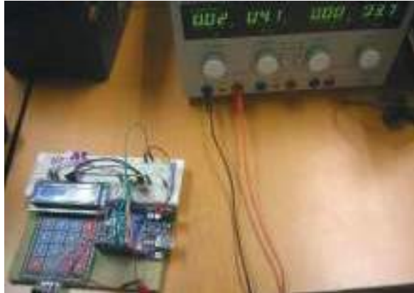
Figura 2. Regulación de voltaje al Arduino con una fuente
